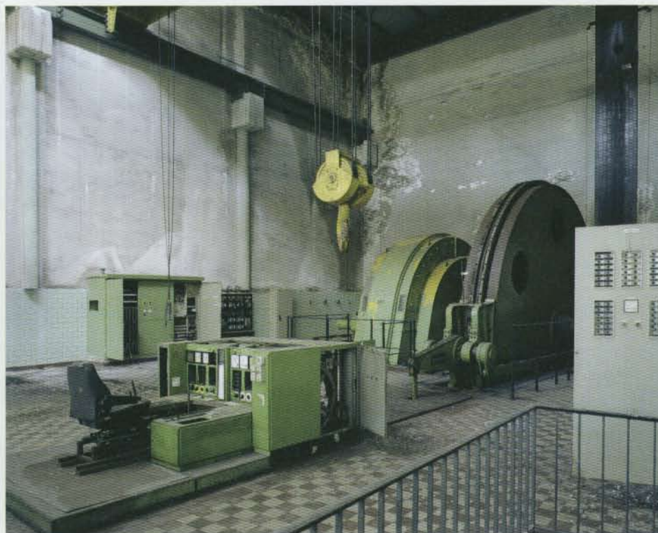
Haiko Hebig: Die Fördermaschinen der Zeche Westfalen 1/2 (Die vier elektrischen Fördermaschinen der stillgelegten Schachanlage Westfalen 1/2 in Ahlen/Westfalen)
